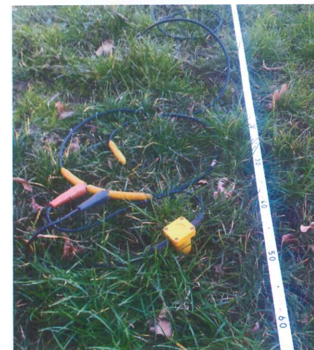
Stendimento sismico per tecnica MASW e dettaglio dei sismografi utilizzati
