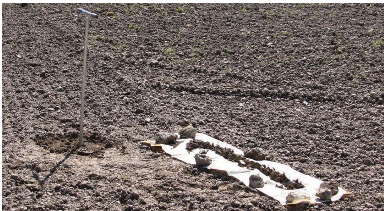
Figura 3.4: Trivellata eseguita con trivella olandese manuale; le carote di terreno estratte vengono posizionate su di un telo per consentire la descrizione degli orizzonti pedologici e il campionamento
