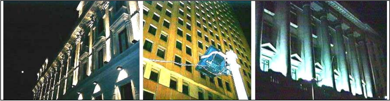
Fig.22 – Tre situazione di illuminazione di palazzi. Nella prima foto a sinistra un palazzo di valore storico con illuminazione mista, dall’alto verso il basso ed entro la sagoma dell’edificio (conforme alla L.r.17/09) e dal basso verso l’alto(non conforme). Nella seconda foto un edificio di nessun valore illuminato dal basso con elevata potenza. Nella terza foto l’illuminazione dell’edificio di alto valore storico fatta dal basso verso l’alto nella sagoma dell’edificio come da L.r.17/09 ma con elevata potenza installata.
