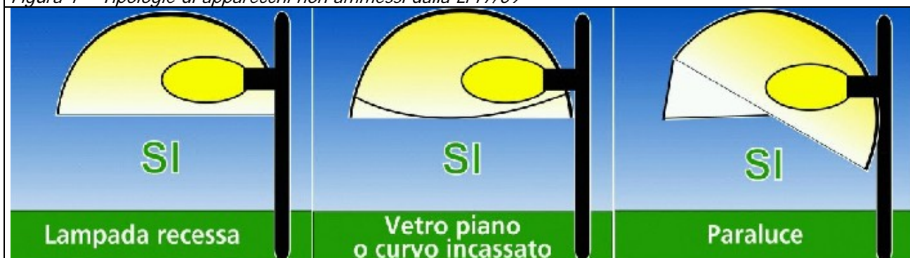
Figura 2 – Tipologie di apparecchi conformi alla legge n.17/09
