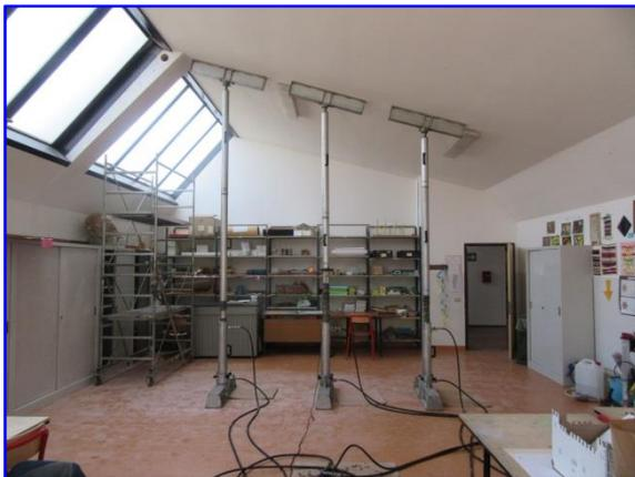
Foto 3: Martinetti oleodinamici per l'applicazione del carico sul solaio
