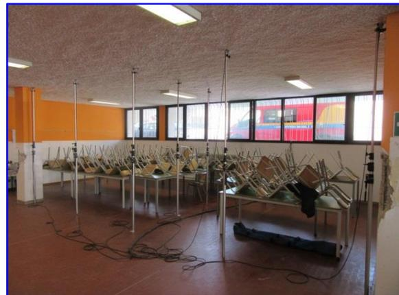
Foto 4: Sensori montati su aste per rilevare i cedimenti in tempo reale
